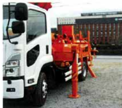
①配管洗浄用エアコンプレッサーは標準装備
